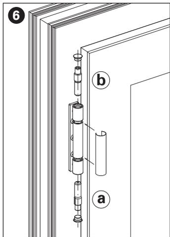
Inserire l'anta nel telaio e avvitare il perno **a** finché l'anello centrale si posiziona al centro rispetto agli anelli laterali.
